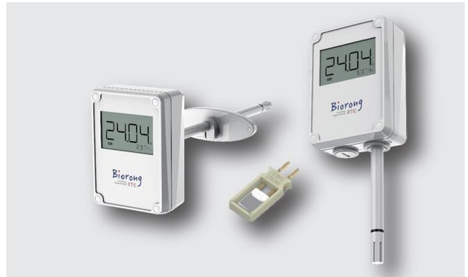
TR12系列无线存储温湿度变送器采用独立的铂电阻测温以及高分子薄膜电容测量湿度，可在暖通空调和洁净室应用等闭环控制系统中实现准确的相对湿度和温度测量。应用方式包括墙面安装和管道安装，具备可用于潮湿区域的IP65防护等级，每个TR1X系列变送器出厂均经过单独校准。如有必要，在有参考的情况下，也可以使用PC对变送器进行现场比对校准。
